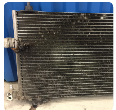
该条件下的冷凝器已无法正常运行，必须更换
