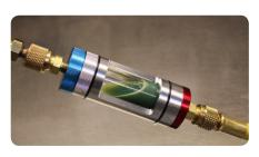
小贴士: 使用额外玻璃检查工具,查看循环回路内可能存在的污染物。该方法经济实用,强烈建议在冲洗前、冲洗中、冲洗后使用,可有效诊断系统内污染情况。
